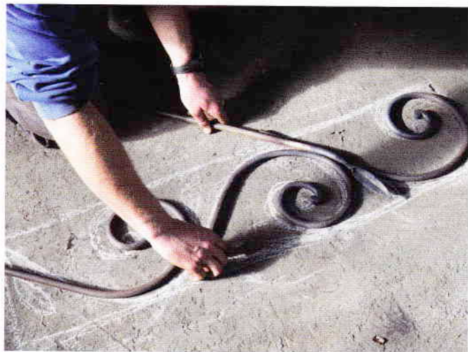
Les décors (flammes, volutes, rosaces, grilles Napoléon III, grilles 1900, initiales du propriétaire ou autre selon les choix du client) sont réalisés à la forge.
