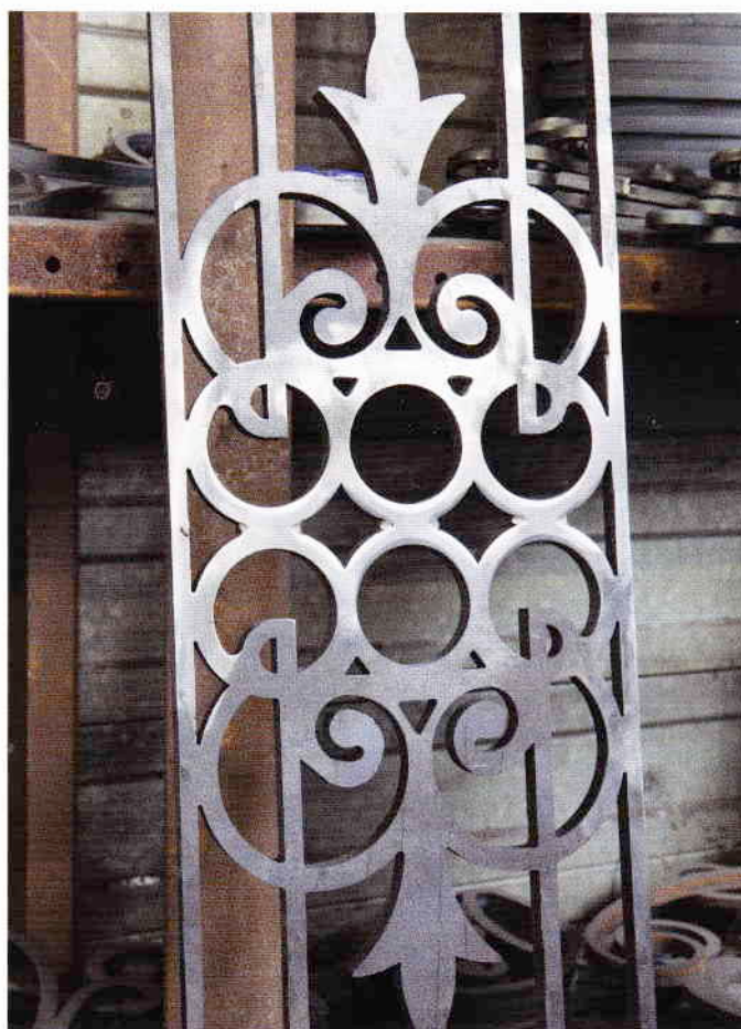
Décor finalisé avant traitement anticorrosion et peinture époxy.
