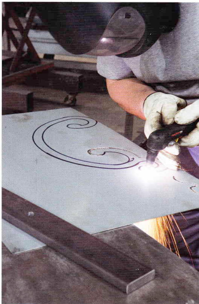
Décor finalisé avant traitement anticorrosion et peinture époxy.
