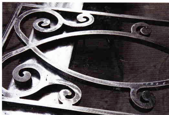
Décor finalisé avant traitement anticorrosion et peinture époxy.
